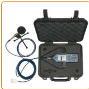
Durch einen Kabeldurchlass werden Mikrofonskabel, Stromversorgungskabel und das Triggerkabel mit der Taste zur Auslösung der Tonaufzeichnung nach außen geführt.
