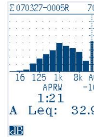
Das Oktavbandspektrum kann mit der A-Bewertung angezeigt werden
