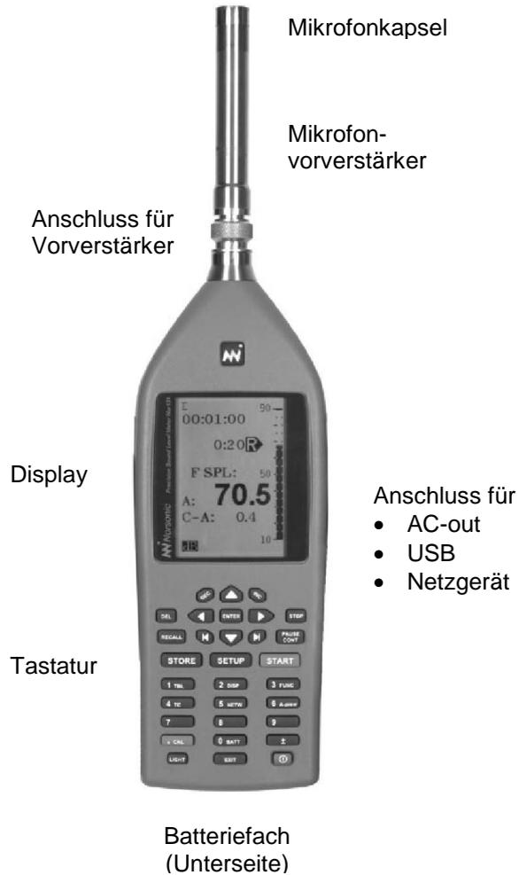
Der Schallpegelmesser Typ 131 misst gleichzeitig die A- und C-bewerteten Spitzen- und RMS-Werte. Dafür benötigt es A- und C-Bewertungsfilter sowie Spitzenwert- und RMS-Detektoren. Zur Vereinfachung weicht die folgende Graphik unten etwas von der tatsächlichen Konfiguration ab.
